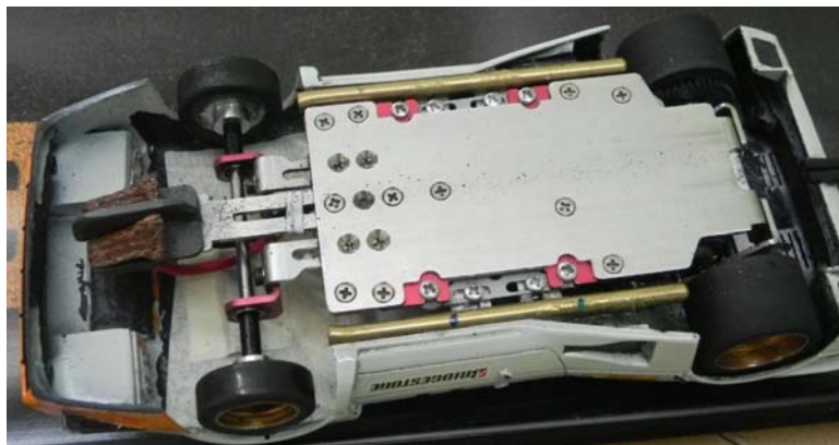
Ferrari 365 GT4/BB von Ralf Grünig von unten: Klassisches Schöler Striker Chassis mit fetten Messing-Gewichtsstangen links und rechts an der Karosserie-Unterkante.
